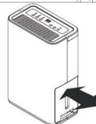
1.4. Encienda el aparato con el interruptor de funcionamiento. Ahora pulse los botones de ajuste de la humedad y establezca la humedad deseada. El valor objetivo del 30% de humedad corresponde en realidad a un funcionamiento continuo.
